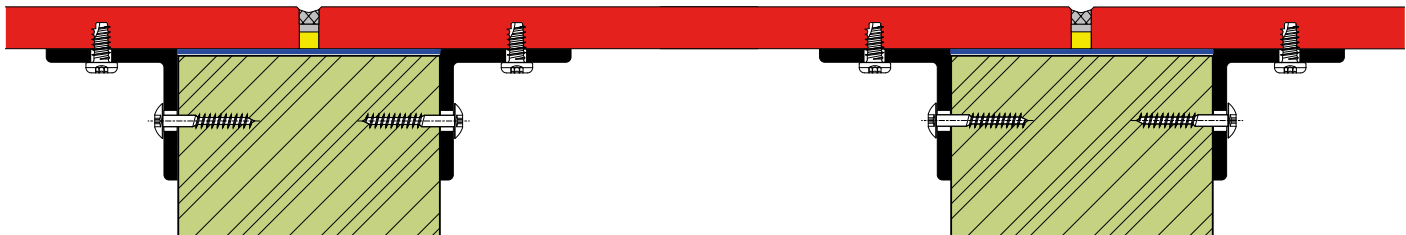
BALKONBODENPLATTE AUF HOLZTRÄM VERDECKT BEFESTIGT (GESCHRAUBT)
