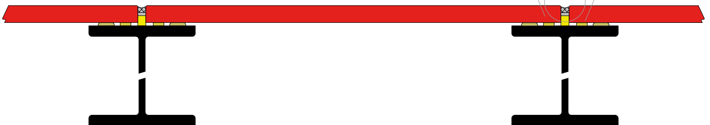
BALKONBODENPLATTE AUF STAHLTRÄGER VERDECKT BEFESTIGT (GEKLEBT)
